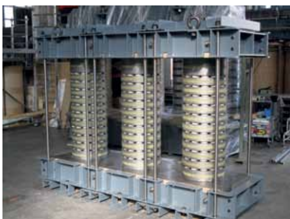
■ Un esempio particolare di nucleo diviso da air gaps
